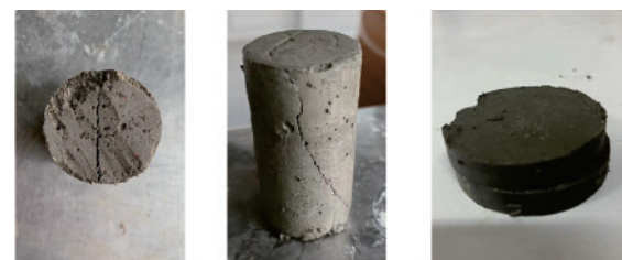
图 6 加载破坏后的试样
